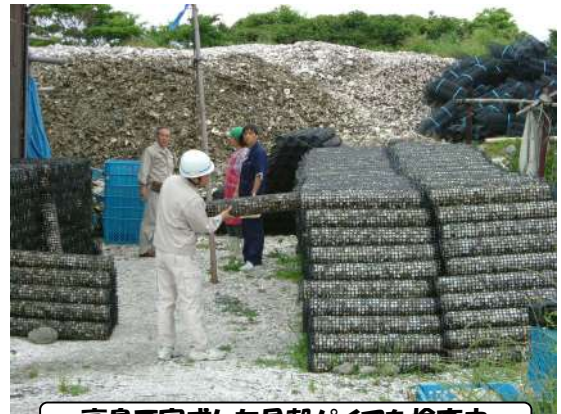
高島で完成した貝殻パイプを検査中
