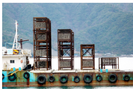
写真-1 水質改善礁（左から 9.0 m 型、7.0 m 型、4.5 m 型、2.2 m 型）
